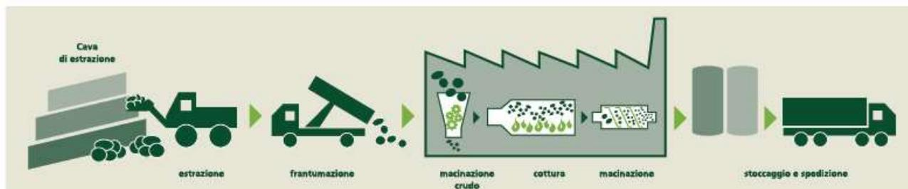
**Figura 3 - Processo di produzione del cemento**
